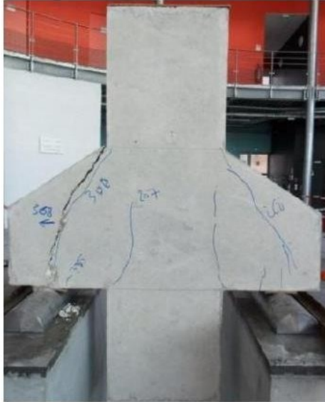
a) C0 : Flexion failure
