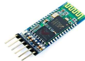
Fig. 1 HC-05 Bluetooth Module
